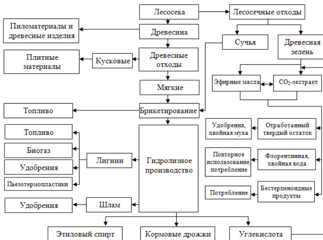
**Рисунок 2 – Принципиальная схема переработки мягких отходов в Лесосибирском промышленном комплексе**
