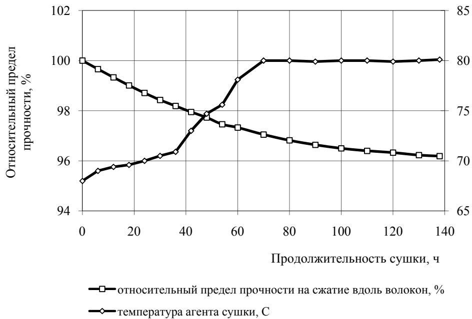
Рисунок 4 – Температура влажного воздуха и расчетная кривая снижения прочности древесины в процессе сушки
